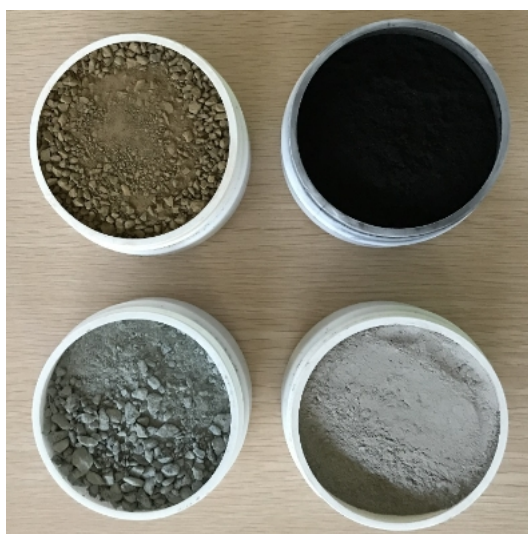
Figure 4. Échantillons utilisés dans le programme d'essais en usine, placés dans des récipients standard de 100 mm de diamètre ; fragments grossiers (à gauche) et pulpes de traitement séchées (à droite). Les couvercles ont été retirés pour montrer le contenu.
