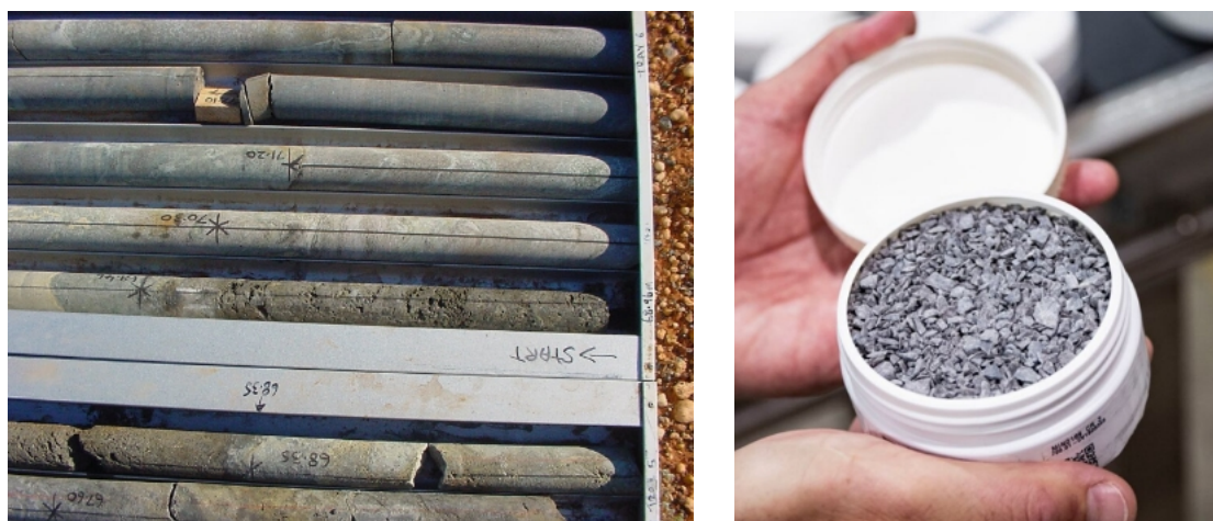
Figure 6. (À gauche) Échantillons de carottes séchés dans des plateaux. (À droite) Bocal « PhotonAssay™ » contenant le matériau de la carotte après concassage jusqu'à une granulométrie maximale d'environ 2 à 3 mm. (Crédit photo de la carotte : MinAnalytical Laboratory Services.)
