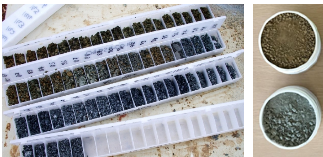
Figure 7. (À gauche) Plateaux de déblais issus d'un forage RC. (À droite) Bocaux PhotonAssay™ contenant des échantillons de carottes après concassage à une granulométrie maximale d'environ 2 à 3 mm. (Crédit photo des plateaux de déblais : MinAnalytical Laboratory Services.)
